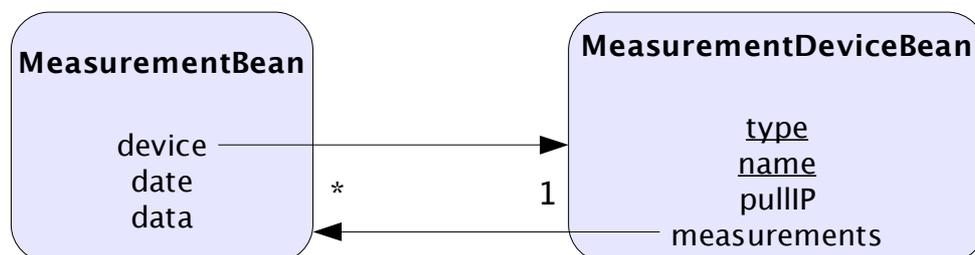
Les liaisons entre les classes **MeasurementBean** et **MeasurementDeviceBean** étant définis comme étant **ManyToOne** d'un côté et **OneToMany** de l'autre, on peut facilement insérer une mesure dans la liste des mesures d'un appareil: il suffit de dire que la mesure provient de l'appareil en question (donc de remplir la partie **ManyToOne**) et Java fera ce qu'il faut pour que la liste des mesures (partie **OneToMany**) de cet appareil soit mise à jour de façon automatique.
